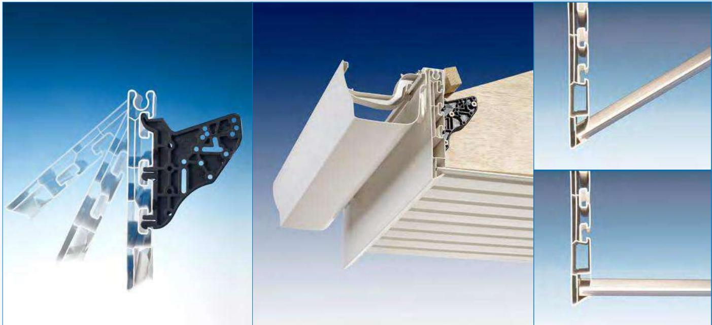
**Deux méthodes de pose** : La première consiste à cliper et faire coulisser le support PVC à l'arrière du bandeau. La seconde repose sur le clipage du bandeau sur les supports déjà fixés aux éléments de charpente.
